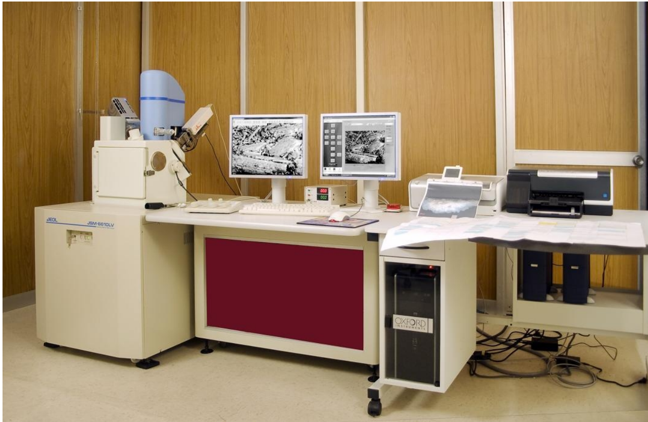
Microscopio electrónico de alto-bajo vacío y fluorescencia de rayos-X JSM 6610 LV
